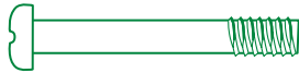
M5 x 1 1/4" (3,2 cm) Bolt - 1 Boulon M5 de 3,2 cm - 1 Perno M5 x 3,2 cm - 1
